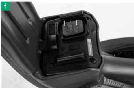
Si vous avez retiré la batterie du tube diagonal ou du porte-bagages de votre vélo électrique VELO DE VILLE : veillez à ce que les connexions de la batterie **[f]** ne soient pas exposées à la poussière ou l'humidité. Placez éventuellement les caches protecteurs fournis sur les connexions de votre batterie. L'écran et l'éclairage surtout ne seront alors plus disponibles. Vous ne devez alors plus rouler en vélo électrique VELO DE VILLE sur des routes publiques.
