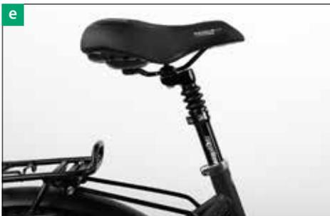
10. Si vous avez fait l'acquisition d'un vélo électrique VELO DE VILLE avec suspension [e], nous vous conseillons de faire procéder au réglage correct de la suspension par votre revendeur VELO DE VILLE. Un réglage incorrect de la fourche à suspension ou des éléments de suspension peut entraîner un mauvais fonctionnement, voire une détérioration des éléments de suspension. Il affectera dans tous les cas le comportement du vélo et ne vous permettra pas de jouir d'une sécurité de conduite maximale.
