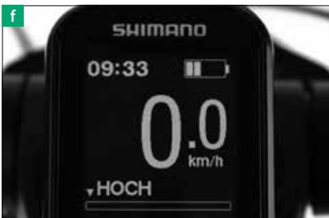
Pour augmenter l'autonomie du vélo électrique, il vous est recommandé de rouler en mode d'assistance réduite ou nulle sur les tronçons de parcours plat ou dans les descentes et d'activer l'assistance maximale [f] seulement en cas de vent contraire, de chargements élevés et/ou dans les côtes à forte déclivité.
