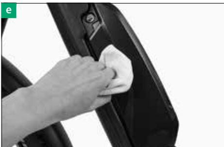
Utilisez pour le nettoyage du boîtier de la batterie un chiffon sec ou, tout au plus, légèrement humecté [e]. Contrôlez si le boîtier est endommagé. Vous ne devez en aucun cas diriger le jet d'un nettoyeur à haute pression sur la batterie car de l'eau pourrait pénétrer à l'intérieur de celle-ci et/ou provoquer un court-circuit. Après chaque nettoyage, vérifiez qu'il n'y a pas d'eau qui aurait pénétré au niveau de la batterie et que les contacts sont secs.
