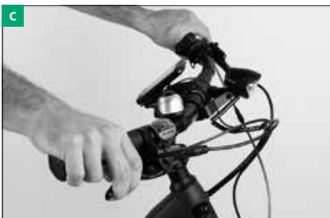
4. Vérifiez que les connexions de la batterie, de l'ordinateur de bord sur le cintre [f, p. 19] et du moteur sont correctement branchées. Pour de plus amples informations, reportez-vous à la notice technique du système d'assistance électrique, par ex. dans le chapitre
