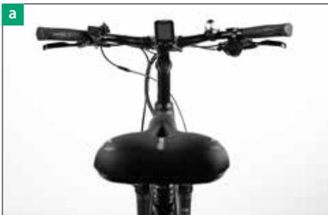
6. Vérifiez l'alignement correct de la selle par rapport au cadre [a] en prenant la boîte de pédalier ou le tube supérieur comme repère. Desserrez éventuellement la fixation de la tige de selle, ajustez la selle, puis resserrez la fixation [b].
