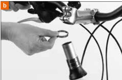
Desmonte el tornillo que da la precarga al juego de dirección, situado en la parte superior del cuello de la horquilla; quite el tapón y desenrosque los tornillos en la cara lateral de la potencia dando hasta tres vueltas [a]. Quite la potencia y los separadores del cuello de la horquilla. Entretanto, sujete el cuadro y la horquilla de manera que la horquilla no caiga fuera del cuadro.
