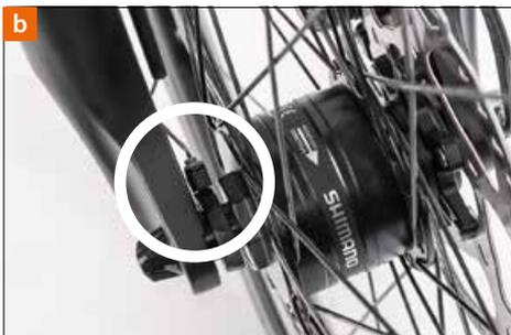
Si la rueda delantera no lleva cierre rápido, necesitará una llave de boca o una llave poligonal de 15 mm o preferiblemente una llave dinamométrica para apretar las tuercas de eje.
