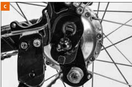
A continuación, suelte la palanca del cierre rápido o las tuercas de eje. Ahora podrá desenganchar la cadena y sacar la rueda trasera del **[c]** cuadro.
