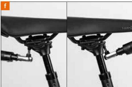
Apriete ambos tornillos de manera uniforme [f], para que el sillín mantenga su ángulo. Si desea inclinar más hacia abajo la punta del sillín, gire el tornillo delantero en sentido horario; puede que, al mismo tiempo, tenga que aflojar un poco el tornillo trasero. Si quiere inclinar más hacia abajo el extremo posterior del sillín, deberá girar el tornillo trasero en sentido horario y, eventualmente, aflojar un poco el tornillo delantero.
