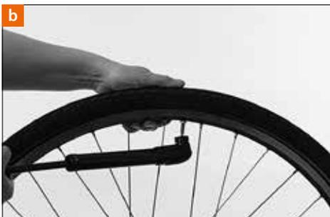
Presione levemente la válvula hacia el interior del neumático para no aprisionar la cámara con el aro del neumático. Asegúrese de que la válvula esté recta. Si este no es el caso, no queda más remedio que desmontar un flanco del neumático y volver a alinear la cámara.
