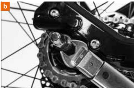
Alinee el orificio del brazo del freno hasta que coincida con el orificio de la abrazadera del brazo del freno y coloque el tornillo de sujeción. Coloque desde atrás una tuerca junto con una arandela en la rosca del tornillo de apriete. Atornille estos componentes entre sí dando unas 3-4 vueltas.
