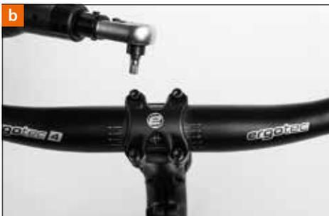
Existen tres sistemas de potencia, con los que se puede ajustar la altura del manillar (potencia convencional, potencia ajustable y potencia Ahead®). Cada uno de estos sistemas requiere conocimientos especiales que no pueden detallarse completamente en las descripciones siguientes. Si no está totalmente seguro o tiene preguntas, consulte con su distribuidor VELO DE VILLE.
