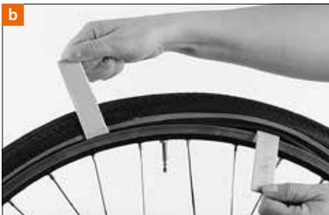
Introduzca un desmontable de plástico en el borde inferior del neumático a aproximadamente 5 centímetros de la válvula y saque el lateral del neumático haciendo palanca en el talón de la llanta [b]. Mantenga el desmontable en esta posición. Introduzca el segundo desmontable a unos 10 centímetros del primero, al otro lado de la válvula, entre la llanta y el neumático, y saque el lateral del neumático haciendo otra vez palanca en el talón de la llanta.
