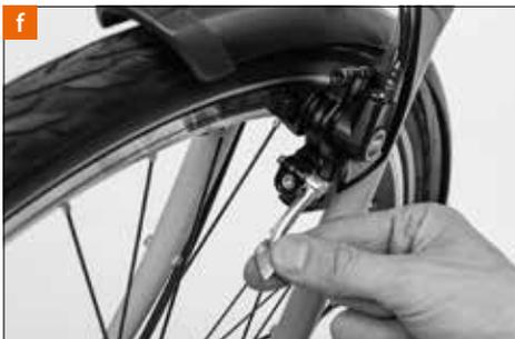
En el caso de **frenos de llanta hidráulicos** de la marca Magura, abra la palanca del cierre rápido situada en un lado del freno [f] y retire el freno de su anclaje.
