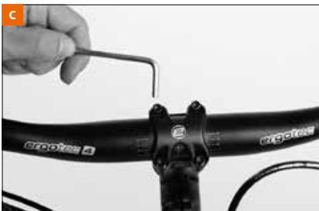
En función del orden en el que vuelva a colocar los separadores [b] y la potencia, podrá determinar la altura del manillar. Los separadores restantes se deben colocar en el cuello de la horquilla, de manera que queden por encima de la potencia. Ajuste el juego de dirección tal y como se describe en el capítulo «Juego de dirección». Si la posición del asiento es adecuada, haga que su distribuidor VELO DE VILLE retire la torre de espaciadores y el cuello de la horquilla que sobresalen.
