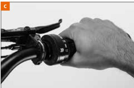
El proceso de cambio se inicia, dependiendo del sistema de cambio que lleve montado la bicicleta, accionando una palanca de cambio o dando un leve giro de muñeca, si tiene un cambio de puño giratorio [c]. Durante todo el proceso de cambio hay que seguir pedaleando; a la vez hay que reducir notablemente la fuerza de pedaleo.
