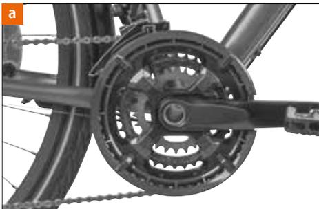
El eje de pedalier [a] es el elemento de unión entre las bielas y el cuadro. Hay distintos tipos: A veces el eje propiamente dicho forma parte del eje de pedalier y otras veces está integrado en la biela derecha. Los rodamientos de bolas herméticos no requieren mantenimiento y se suministran sin holgura de fábrica. El asiento firme del eje de pedalier en el cuadro y de las bielas en el eje debe ser verificado periódicamente.
