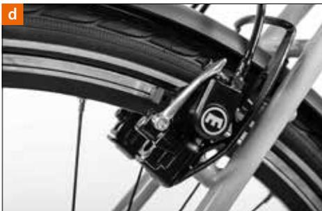
En bajadas largas, acostúmbrese a frenar de forma breve y firme al mismo tiempo, desbloqueando el freno regularmente entre frenado y frenado. Si tiene dudas, deténgase un rato y deje que los frenos se enfríen.
