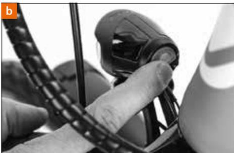
Vuelva a apretar el tornillo gradualmente en sentido horario hasta que el faro quede completamente fijo en su soporte.
