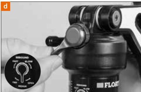
A continuación, pase por un obstáculo (p. ej., baje por el bordillo de la acera) y vaya cerrando, en pequeños pasos, la amortiguación de rebote (en dirección de «+» o «slow») hasta que la parte trasera, después de comprimirse y extenderse, no rebote más de una o dos veces. Haga siempre una salida de prueba en terreno accidentado después de modificar el ajuste.
