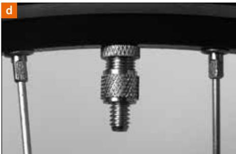
En el caso de la válvula Dunlop [d], afloje la tuerca moleteada hasta que el aire salga pasando por el lado de la válvula. Después, vuelva a apretar la tuerca moleteada. Por regla general, el neumático se debe volver a inflar por completo.
