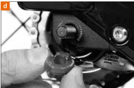
Tense la cadena y apriete las tuercas de eje con un par de 30-45 Nm [e] para fijar la rueda al cuadro.
