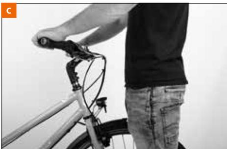
Oriente el manillar de forma que no esté desaliniado cuando conduzca en línea recta. Vuelva a apretar el tornillo en la parte superior de la potencia con una llave dinamométrica.
