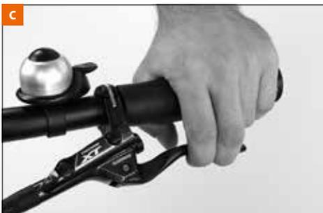
Accione ambos frenos a la vez y recuerde que, debido a la transferencia de pesos, el freno delantero transmite fuerzas mucho mayores que el freno trasero en suelo no resbaladizo.
