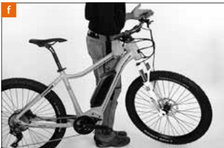
Para comprobar el funcionamiento suave del juego de dirección, levante el cuadro con una mano, hasta que la rueda delantera deje de tocar el suelo. La rueda delantera tiene que girar, sin atascarse, de un extremo a otro y viceversa. A la menor pulsación en el manillar, la horquilla debe moverse espontáneamente desde la posición central [f].
