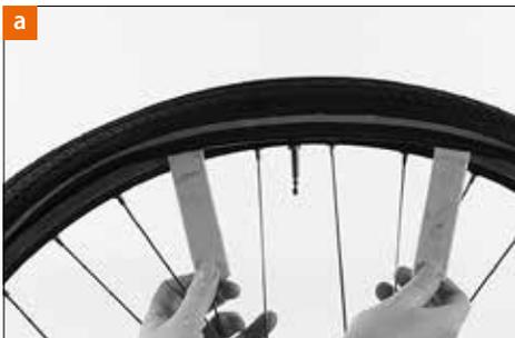
Antes de introducir el neumático por completo en la llanta, vuelva a verificar la posición de la cámara y haga pasar entonces el neumático por encima del borde de la llanta, empujándolo con la base del pulgar.
