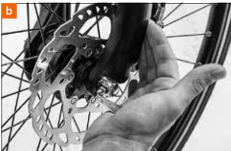
Lleve la palanca del cierre rápido a la posición de apriete hasta que se pueda leer la inscripción «close» (cerrado) en su cara externa. Desde que se inicia el movimiento de cierre hasta la mitad del recorrido, la palanca debe dejarse accionar con mucha facilidad.
