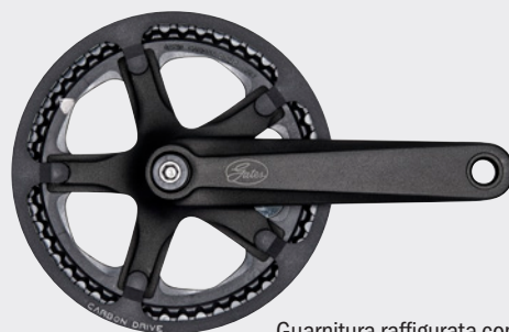
Guarnitura raffigurata con protezione conforme alle norme ISO
