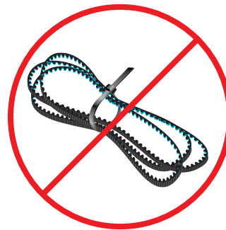
NICHT MIT KABELBINDER BINDEN
