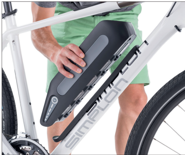
Einsetzen externer Akku UR-V2
