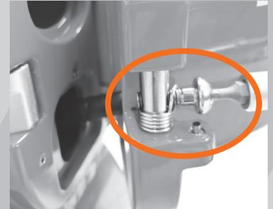
Der Kopf der Hebelschraube muss in der entsprechenden Aussparung des Hebels sitzen.
